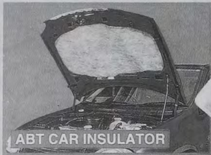
ฉนวนกันความร้อนตู้ห้องเครื่องตอนหน้า
