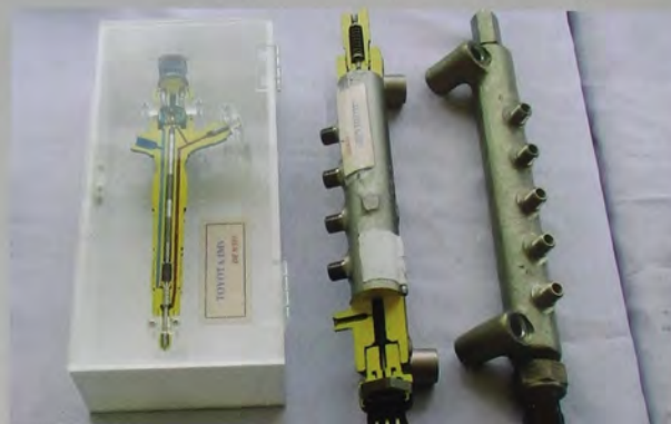
หัวฉีดและท่อรางน้ำมัน ส่วนสำคัญในเครื่องยนต์คอมมอนเรล
