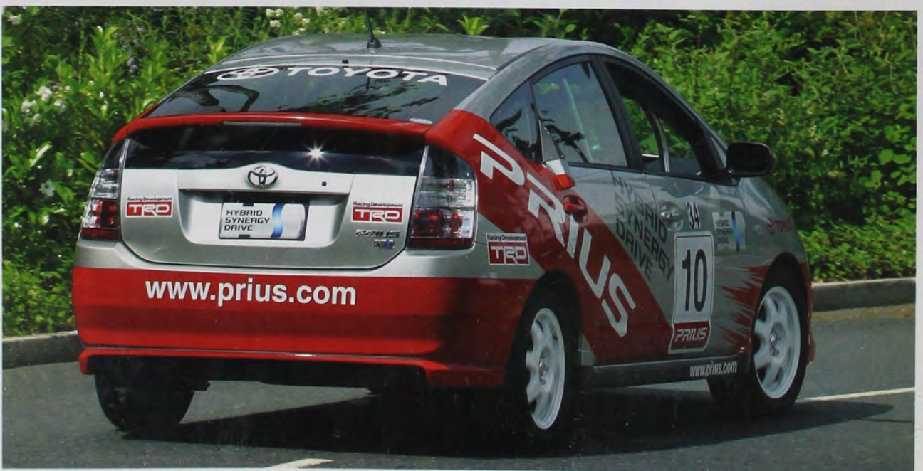
รถแนวคิด โตโยตา ปริอุส จีที ปรากฏตัวในงานมหกรรมยานยนต์ปารีสครั้งล่าสุด เมื่อปลายเดือนกันยายน 2004 เพิ่มกำลังเครื่องยนต์จาก 77 เป็น 99 แรงม้าและเพิ่มกำลังมอเตอร์ไฟฟ้าจาก 68 เป็น 82 แรงม้า สามารถทำความเร็ว 0-100 กม./ชม. ใน 8.7 วินาที
