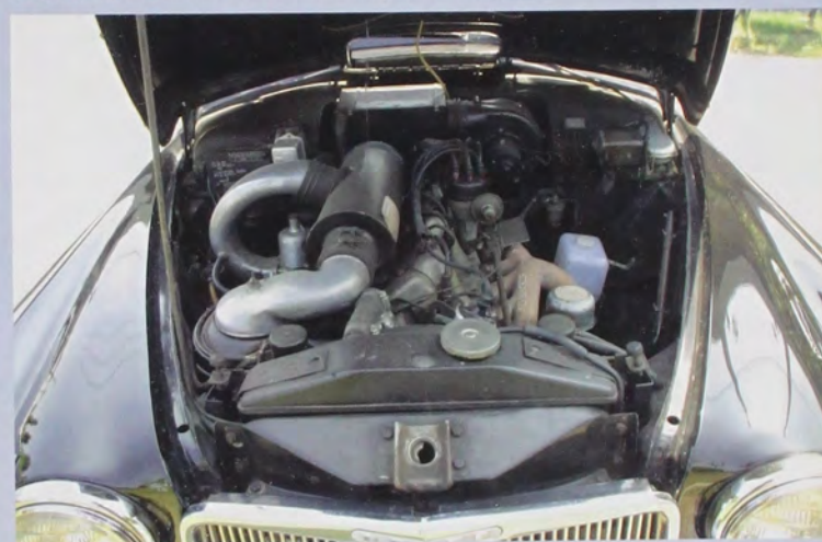
เครื่องยนต์ 6 สูบ แถวเรียง 2.625 ซีซี 104 แรงม้า...แรงใช้อยู่
