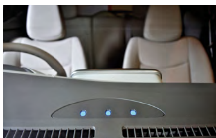
บนคอนโซลหน้ามีไฟแอลอีดีแจ้งสถานะของแบตเตอรี่
