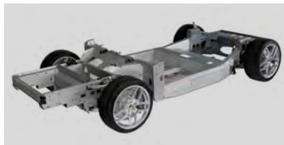
แชสซีส์ทำจากอลูมิเนียมน้ำหนักเบา
