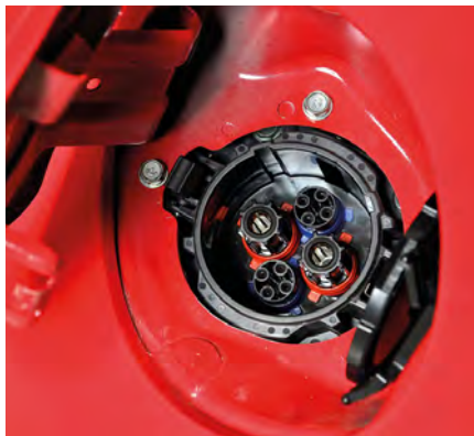
จุดเติมน้ำมันถูกแทนที่ด้วยที่ชาร์จกระแสไฟฟ้า
