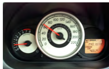
มาตรวัดแสดงความเร็ว 62-63 กม./ชม. อัตราสิ้นเปลืองอยู่ที่ 4 ลิตร/100 กม.
