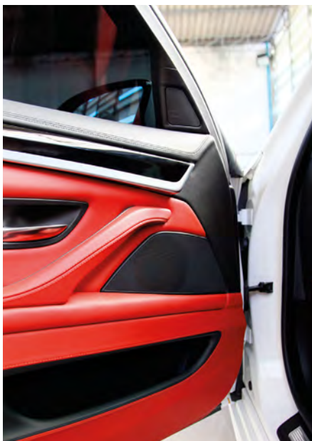
ลำโพงติดตั้งของประตูเดิม โดยไม่ตัดเจาะ
