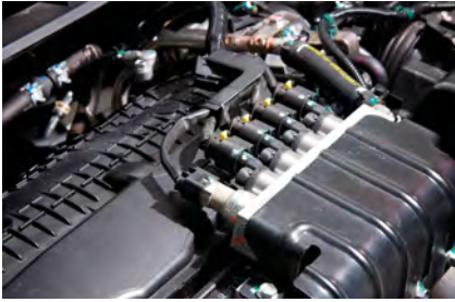
หัวฉีดแกสของ BRC ท่อไอดีสำหรับรถรุ่นนี้โดยเฉพาะ
